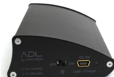
低阻抗耳机也有不错效果。ADL Stride具有的DAC及随身耳扩的功能非常丰富，透过内建的电池以及mini jack Line in的端子，使得用家可以轻松连接手机、数码流播放器等随身听讯源，在使用上，厂方表示它可以提供长达80小时的续航力，这让许多随身耳扩难以望其项背，而笔者在使用过程中连接电源起来也是相当方便，只要通过mini USB介面连上电脑作为USB DAC来使用，这一枚USB接收晶片原来是采用了与ADL得奖大作GT40相同的Tenor TE7022L晶片，TE7022L可以支援24bit/96kHz的档案格式，足以应付大部份的数码流音乐文件；DAC晶片则采用了Wolfson WM9716，我们知道只要是装有Wolfson的晶片的机器，几乎都能拥有出色的声音，因为Wolfson清晰干净的特点，也是让Stride拥有好声音的关键之一。
